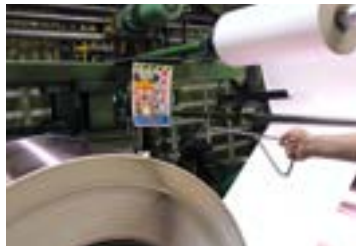
酸洗設備之捲料機於移除廢料使用專用勾取工具
