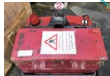
電動拖板車加裝警示燈及音響警報器
